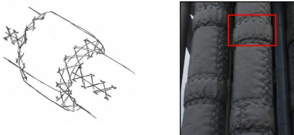
Figura 5: Esquema de fixação cabo de aço jaqueta de PFP
