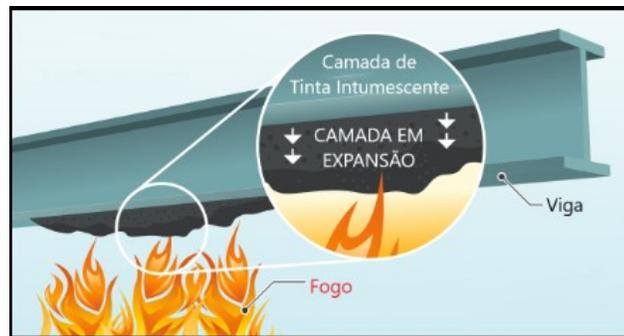
Figura 2: Demonstração da reação da aplicação da tinta intumescente
