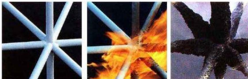
Figura 3: Fases da tinta intumescente exposta ao fogo
