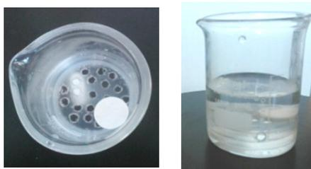
Figura 9: Imagens do sistema elaborado para os ensaios de liberação do ibuprofeno imobilizado nas matrizes de sílica mesoporosa.
