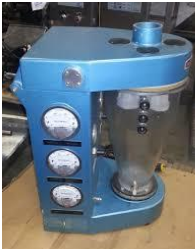
Figura 15 - equipamento de leito fluido utilizado por KORTEBY, et al., 2018. Fonte: PHOENIX EQUIPMENT CORPORATION
