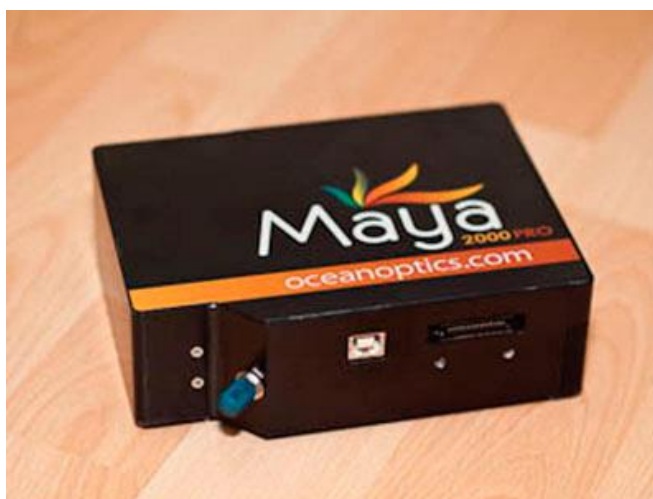
Figura 17 - mini-espectrômetro usado no trabalho de JÄHME, et al., 2016. Apresenta medidas de 148.6 x 109.2 x 46.4 mm. Fonte: OCEAN OPTICS
