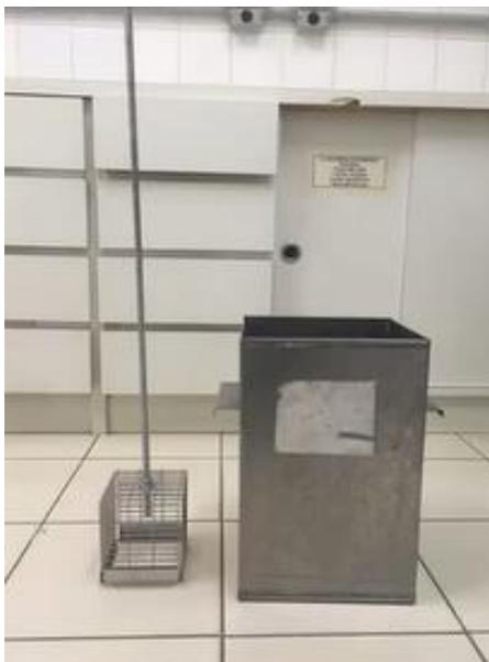
**Figura 1.** Aparato e grade metálicos utilizados no protocolo de UWT. Foto cedida pela estudante Natália Zanta.
