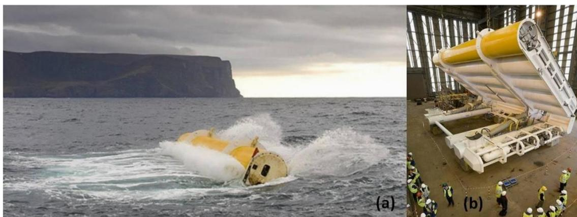
Figura 12: (a) Oyster de 315 kW, instalado para testes em novembro de 2009. (b) Oyster 1 antes do comissionamento. (Fleming F.P., 2012).
