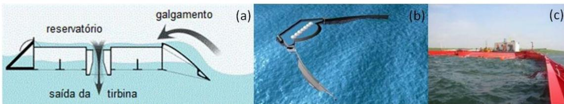
Figura 13: (a) Esquema do princípio de funcionamento do dispositivo de galgamento. (b) Esquema da visão aérea do dispositivo Wave Dragon no mar. (c) Foto do reservatório do dispositivo testado no mar. (Fleming F.P., 2012)
