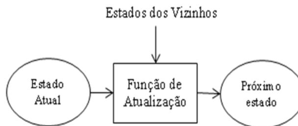
**Figura 11:** Função do estado de transição da célula.
