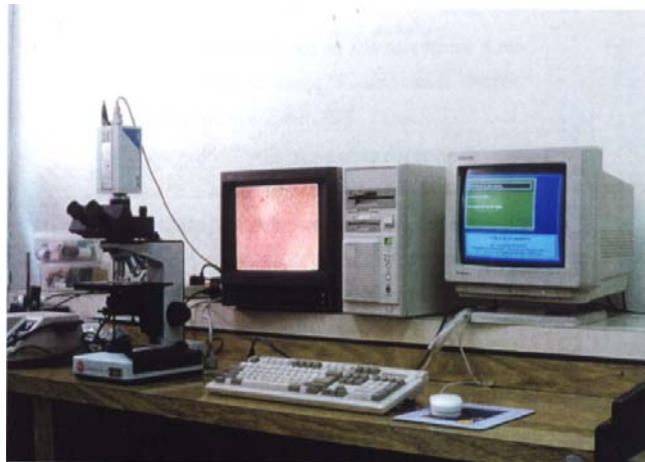
Figura 7- Equipamento necessário para a realização da análise de imagem assistida por computador
