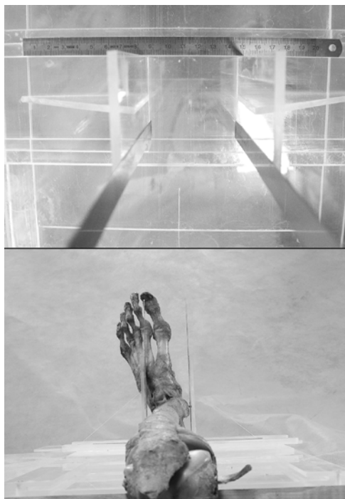
Figura 2 - Visão coronal do conjunto de três réguas, abaixo visão axial do aparato onde observamos um membro inferior já posicionado para aferição.
